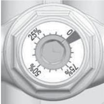
Die jeweilige Stellung der Regeleinheit wird deutlich lesbar, in Prozent, angezeigt. Die gewünschte Voreinstellung ist komfortabel einstellbar. Der voreigestellte Volumenstromregler ist jederzeit Absperrbar bzw. kann in beliebiger Position eingestellt werden.
